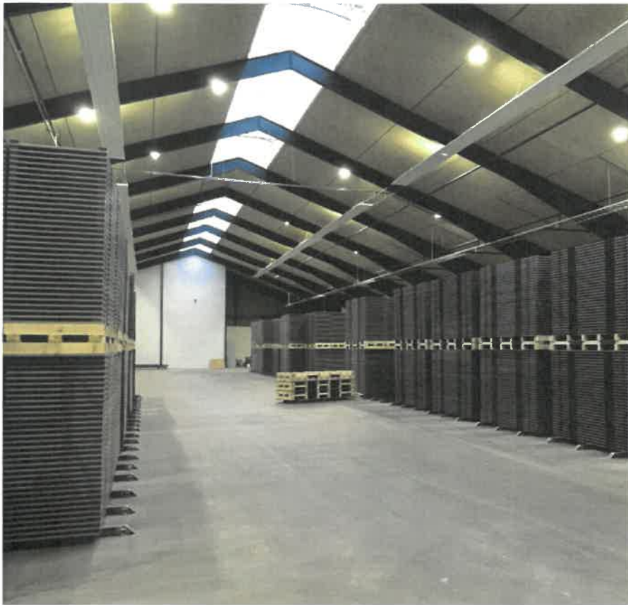
Plast i kilometervis - Troldekt producerer loftplader. I forbindelse med deres nye produktionsanlæg, har de anvendt kilometervis af firkantprofiler i PEHD 500 regenerat til kanterne på støbeforme.
