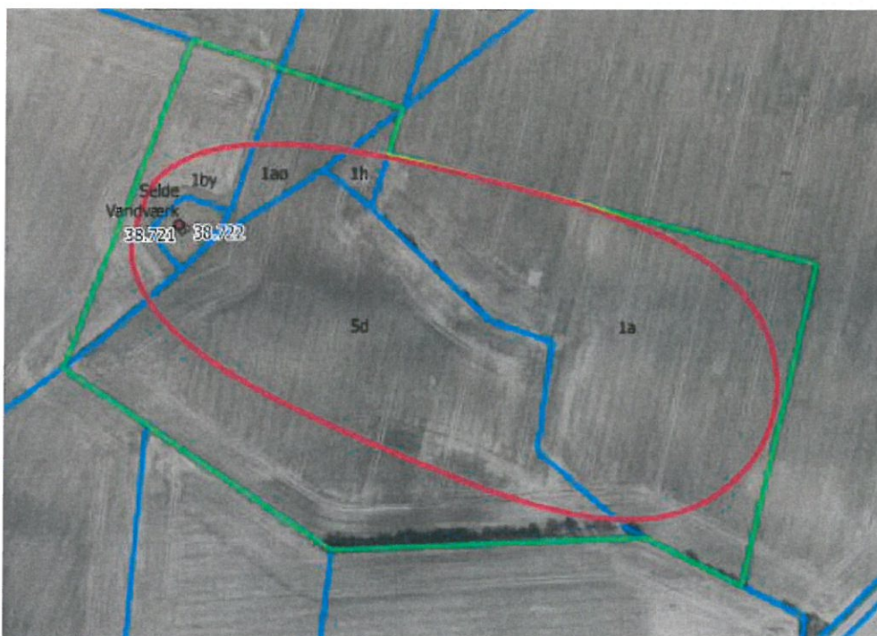
Boring tilhørende Selde vandværk. Rød streg markerer BNBO området. Grøn streg markerer forslag til område med dyrkningsrestriktioner. Blå streg er skel.
