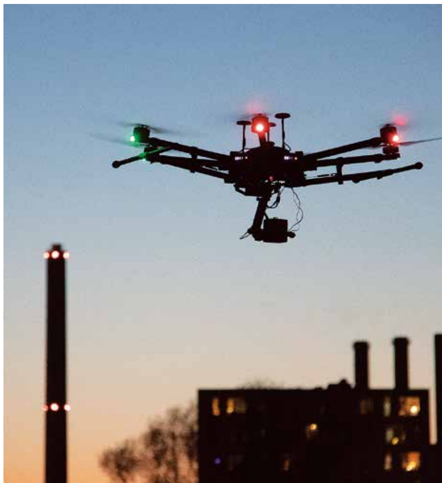
Droner bliver taget i brug for at finde lækager i forsyningsnettet.
