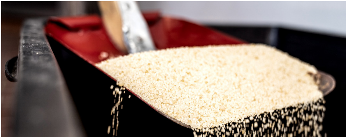
Kalkpellets fra blødgøringsprocessen på Brøndbyvester Vandværk
