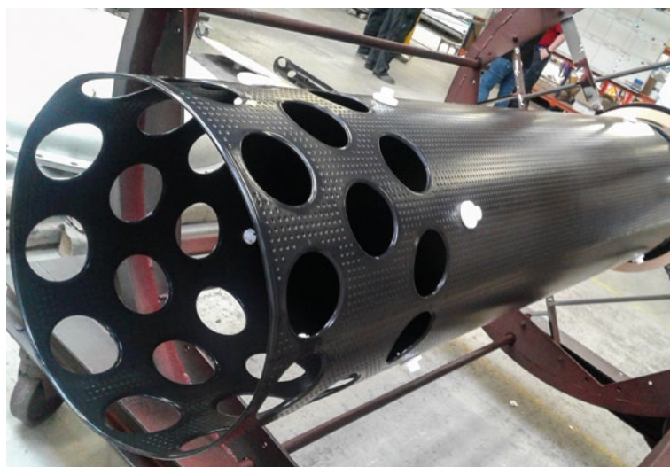
Procesudstyr med korrosionsbeskyttende Accoshield belægning.
