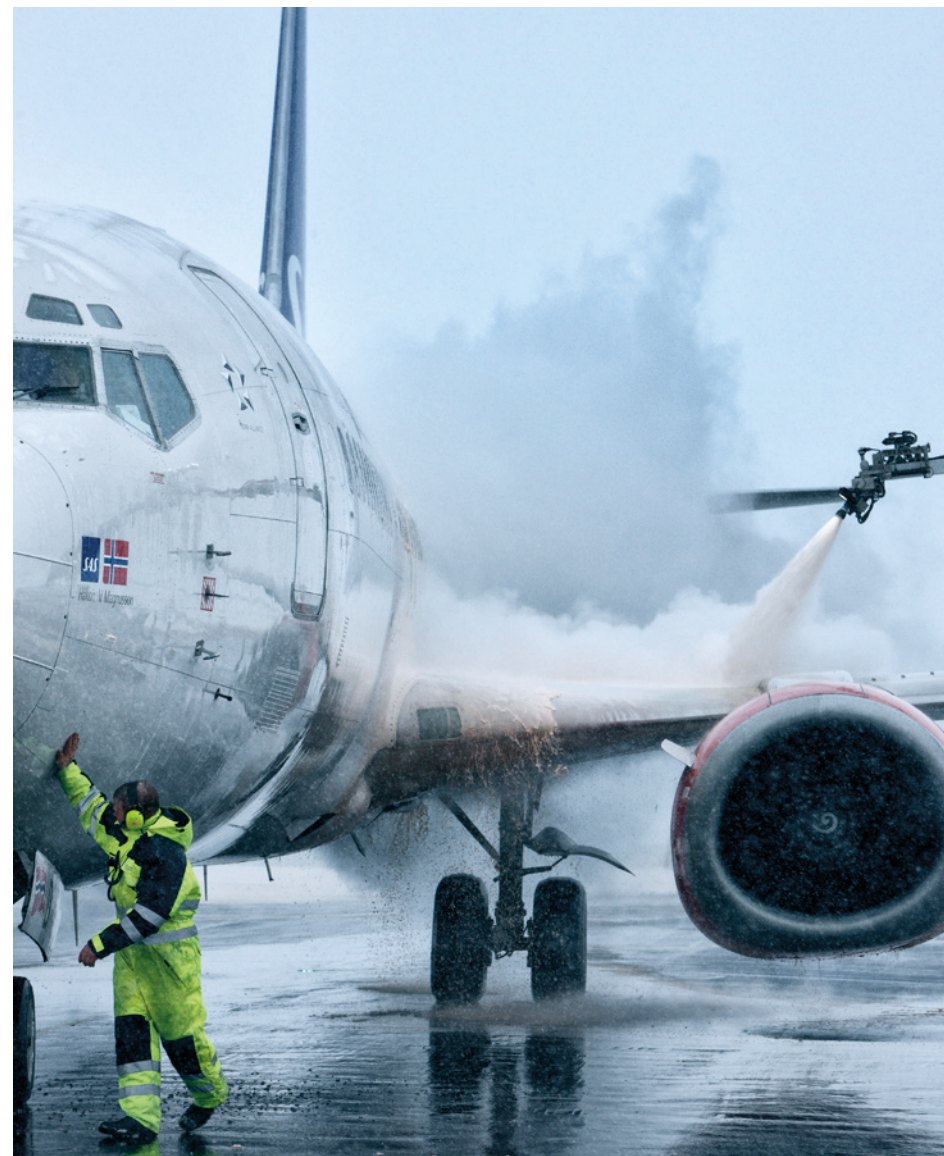
Afisning af fly fjerner sne og is fra flyets vinger for at forhindre isdannelse på vinger og flaps under take-off. Afisningen foretages lige inden take-off på platforme med opsamlingsystemer til den overskydende afisningsvæske.
